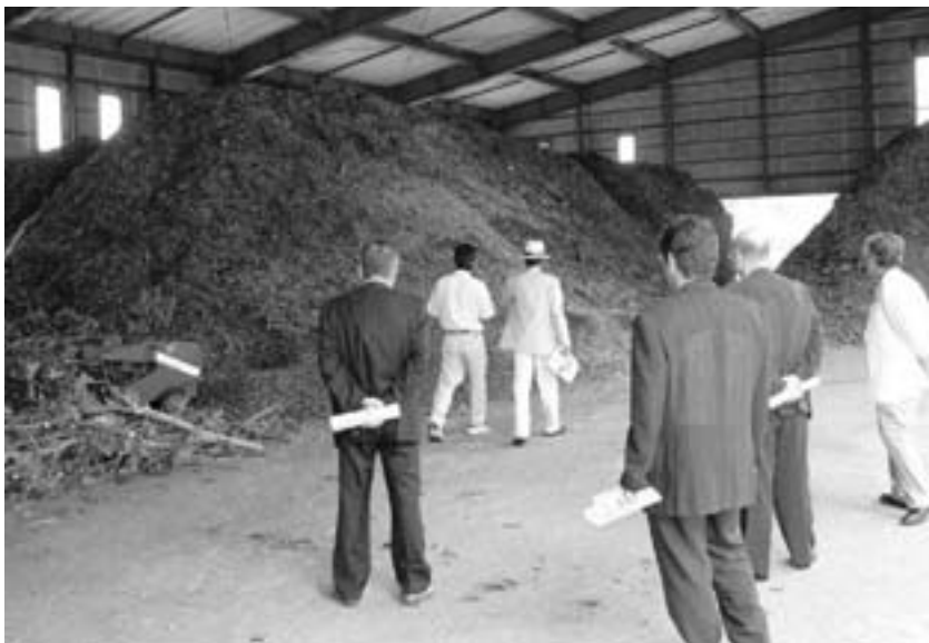
パークと呼ばれる伐採した樹木の樹皮を粉碎したもの。堆肥の水分調整材として使用される。
